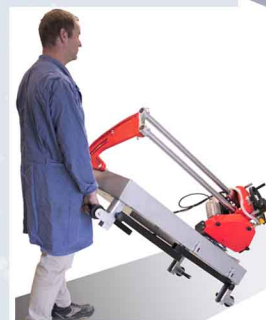
Schuin gestelde zaagkop voor het verstekzagen.
